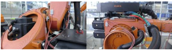
Bild 2: Blick auf die an den Achsen 1, 2 und 3 angebrachten Heizmatten am Roboter des Typs KR60 HA von Kuka.
